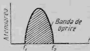
Fig. 40. Curba de răspuns, în funcție de frecvență, a filtrului oprește-bandă.
