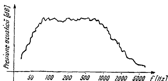
Fig. 3.34. Caracteristica de redare a unui difuzor de joasă frecvență.
