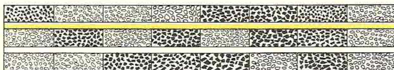
b) Straturile filmului după prima dezvoltare (negru-alb) grăunți negri = argint dezvoltat, grăunți albi = bromură de argint neimpresionată; stratul de filtru galben încă existent
