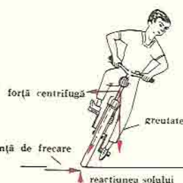
Fig. 3. Forțele care acționează asupra conducătorului la efectuarea unei mișcări circulare
