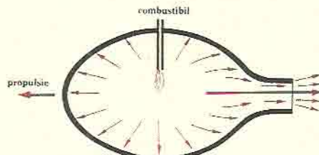
Fig. 3b. Particulele gazoase evacuate creează propulsia
