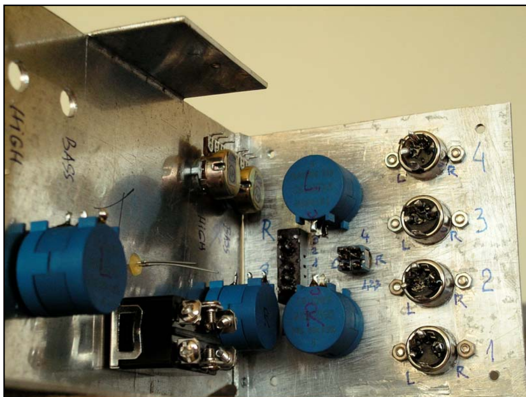
Potențiometrele, mufele, întrerupătoarele și comutatoarele de pe panelul de bord și lateral Plăcile laterale de fixare a mufelor de intrare și a comutatoarelor
