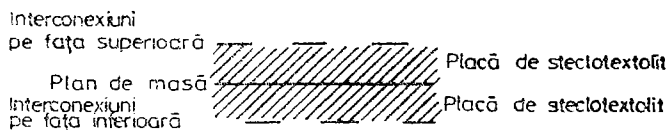
Fig. 12-9. Secțiune transversală printr-o placă cu cablaj multistrat.
