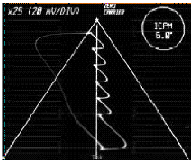
Fig. 8.13 Afișaj ICPM cu distorsiuni de 6^0 determinate cu gradații a electronică
