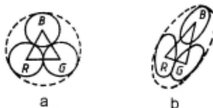
Fig.7.10 Efectul de astigmatism în cazul tubului cinescop delta :
