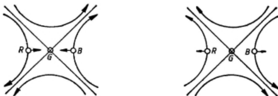
Fig. 7.15 Deplasarea fasciculelor de electroni în câmpul magnetic 45^\circ/45^\circ din tuburile tricrom în linie (PIL)
