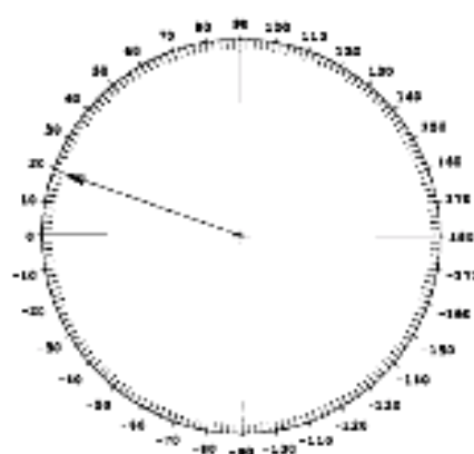
Fig. 8.11 Ecranul aparatului VM700T în regim de măsurare a fazei SCH .
