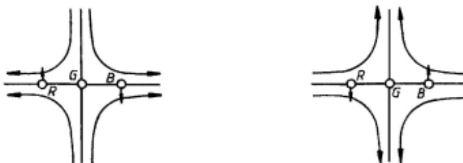
Fig.7.16 Deplasarea fasciculelor în câmpul magnetic 0/90^\circ
