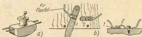
Fig. 159. Comutatorii: a — comutator (chipșalter) de fabrică, de dimensiuni mici; b — comutator făcut de amatori
