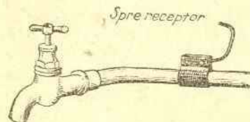
Fig. 19. Țeavă de canalizare întrebuințată ca priză de pământ
