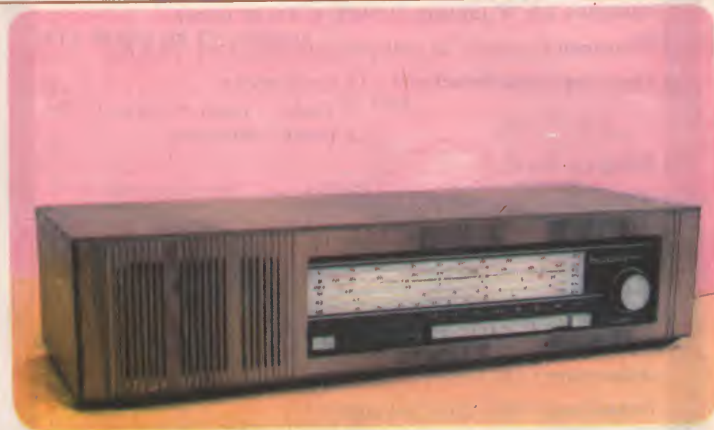
Радиоприемник стационарный с транзисторами класса А для модулированных по амплитуде или частоте.
