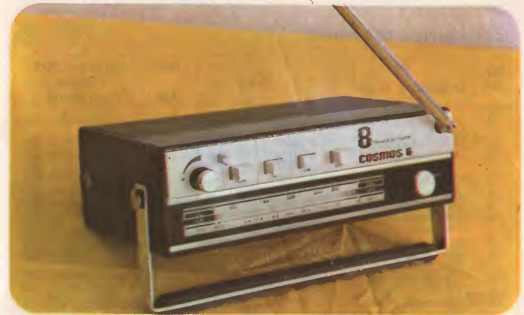
Radioreceptor portabil, clasa a III-a, destinat recepției emisiunilor cu modulație de amplitudine sau frecvență.
