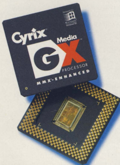
Cyrix MediaGX: destinat din proiectare PC-urilor ieftine și calculatoarelor mobile, MediaGX dispune acum și de instrucțiuni MMX.
