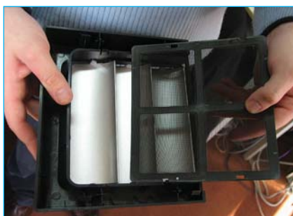
Sită pentru filtrarea aerului care pătrunde în carcasă
