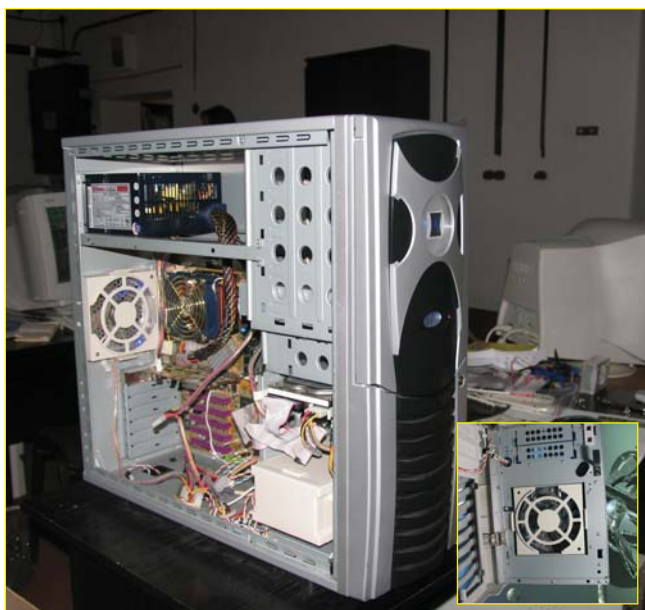
Ventilator interior în fața carcasei cât și în spatele ei
