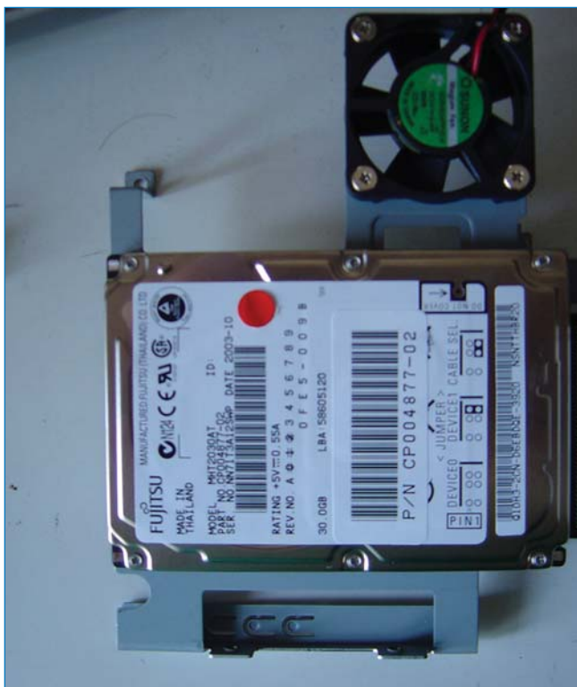
Hard disc Fujitsu de 2,5 inci - capacitate 30 GB
