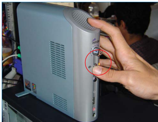
Sistemul KVM - alternarea prin apăsarea unui singur buton de la PC la sistemul Nimble
