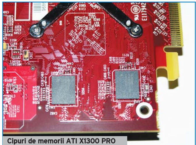
ATI Radeon X1300 Pro: 4-conducte / nucleu tactat la 600MHz / memorie la 800MHz (256MB) - preț recomandat 149 USD
