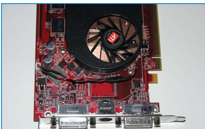
ATI Radeon X1600 XT: 12-conducte / nucleu tactat la 590MHz core / memorie tactată la 1,38GHz (256MB) - preț recomandat 249 USD.
