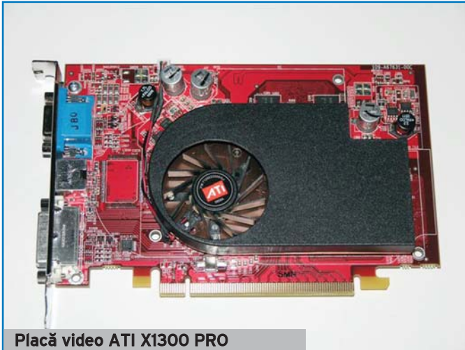
ATI Radeon X1300 Pro: 4-conducte / nucleu tactat la 600MHz / memorie la 800MHz (256MB) - preț recomandat 149 USD
