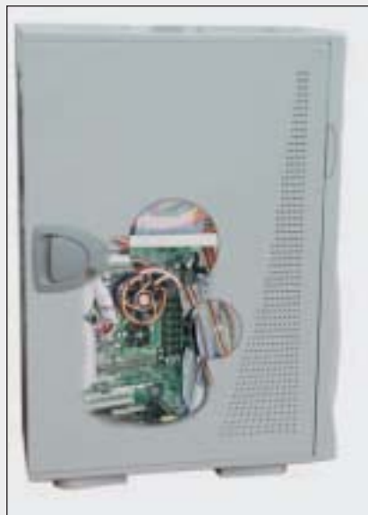
Panoul lateral cu clapă facilitează accesul în interior fără șurubelniță
