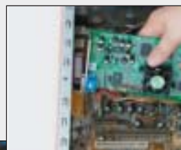
Poziționați placa video în slotul corespunzător
