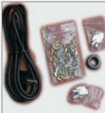
Cablul de alimentare, șuruburi, inel de ferită - toate acestea ar trebui să se afle în cutia carcasei la achiziție
