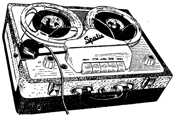
Рис. 4. Магнитофон «Spalis» с дополнительной универсальной головкой
