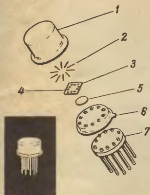
Рис. 1 Конструкция цилиндрического корпуса ТО-5. 1 — цилиндрический колпачок, 2 — соединительные проводники, 3 — интегральная схема, 4 — контактные площадки, 5 — припой, 6 — фланец из кобальта, 7 — выводы из кобальта, изолированные от фланца стеклом специального состава
