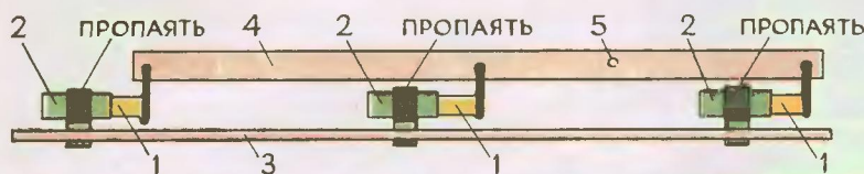
Рис. 2. Конструкция конденсаторов связи C_{52} , C_{61} , C_{62} . 1 — конденсаторы типа КТК, 2 — медная фольга, 3 — монтажная плата, 4 — пластина из гетинакса, 5 — отверстие.
