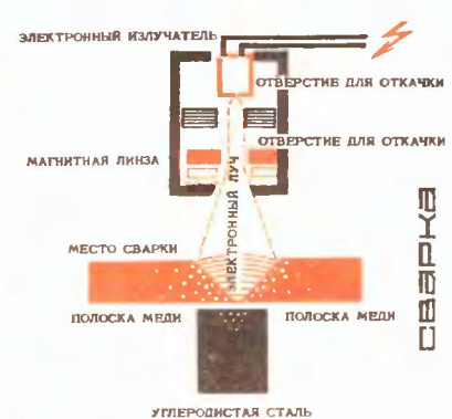
Установка для электроннолучевой сварки типа SE 30 5 мощностью 6 кВт
