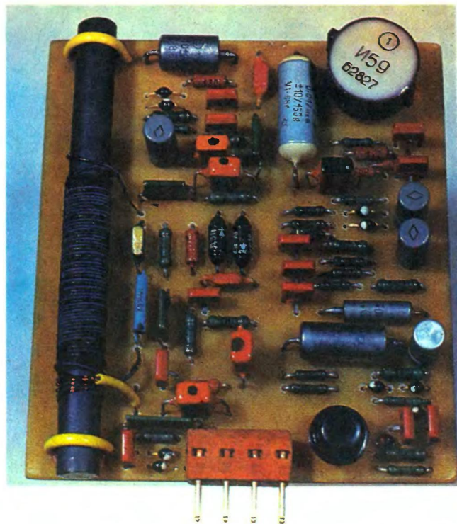
Рис. 3. Расположение деталей на печатной плате.
