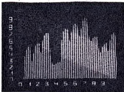
1. Фото с экрана телевизора. На экране телевизора показана сформированная электронным путем гистограмма, отображающая электрические параметры, полученные в системе многооточечного контроля. Такие устройства заменяют громоздкие пульты с большим числом стрелочных приборов.
