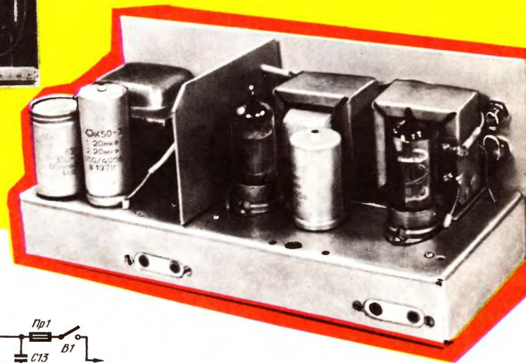
Размещение деталей на шасси усилителя
