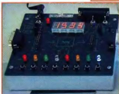
Учебный лабораторный стенд "ПЛИС-1".
